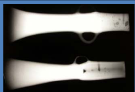
Radiografía de las hachas de Baza y Cangas de Onís del MAN en las que además de los defectos de fundición se visualiza la extracción de muestra de Siret. Radiografía IPHE.
